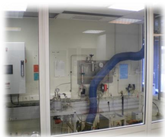
Figure 4.8 : Cellule sécurisée mise en place pour accueillir la boucle de séchage supercritique automatisée (autoclave de 1 litre) – Profil de température et pression suivi lors du séchage
