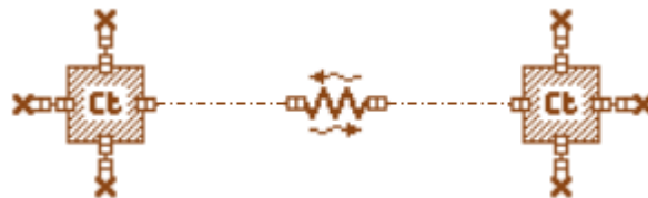
Figure 2.36 : Esquisse de modélisation pseudo Bond Graph du phénomène de conduction à travers une paroi sous AMESim
