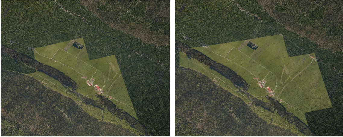
FIGURE 1.23 – Phénomène de popping dû à l'utilisation de niveaux de détail discrets par (Michael WIMMER et SCHEIBLAUER, 2006). Les deux vues sont obtenues avec la version en ligne du logiciel Potree depuis deux points de vues proches (le budget de points utilisé est de 1.5 Mpts). On voit apparaître et disparaître les niveaux de détail discrets.
