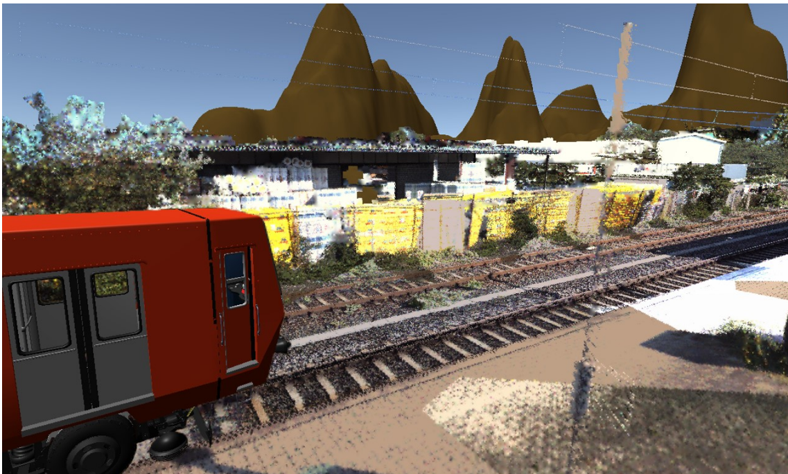
FIGURE 1.55 – Vue du prototype de simulateur de conduite ferroviaire réalisé dans le cadre du stage de Raphaël Groscolt encadré durant cette thèse. Ici le moteur de rendu de nuages de points est interfacé avec l'environnement de simulation Unity, dans lequel a été créé un scénario avec un train et des panneaux de signalisation virtuels.
