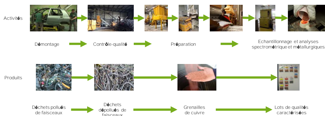
Figure 38 : représentation sélective des activités et produits de la chaîne de valeur de recyclage du cuivre
