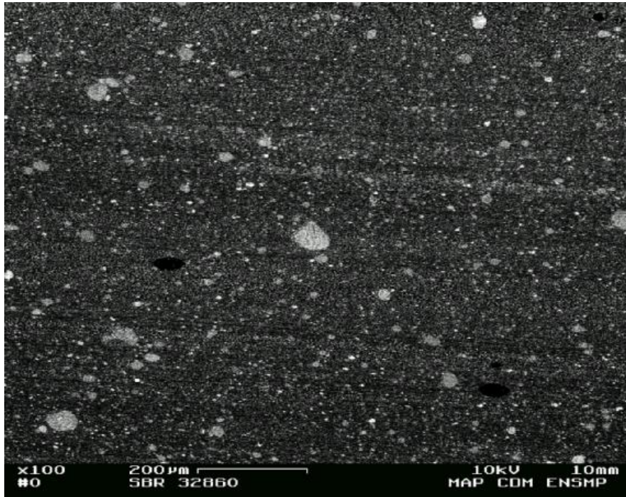
Figure 1.3 – SBR A – Surface plane observée au MEB : gomme, charges de silice (en clair) et de noir de carbone (en noir)
