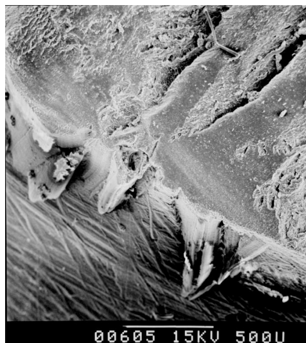
Figure 4.46 – AE38 – Détail d'une zone dite 'fripée' – Défauts de surface correspondant à des bourrelets de caoutchouc
