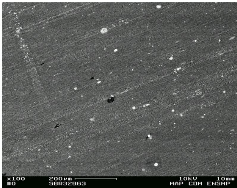
Figure 1A.1 – SBR B – Surface plane observée au MEB : gomme, charges de silice (tâches claires) et de noir de carbone (tâches sombres)
