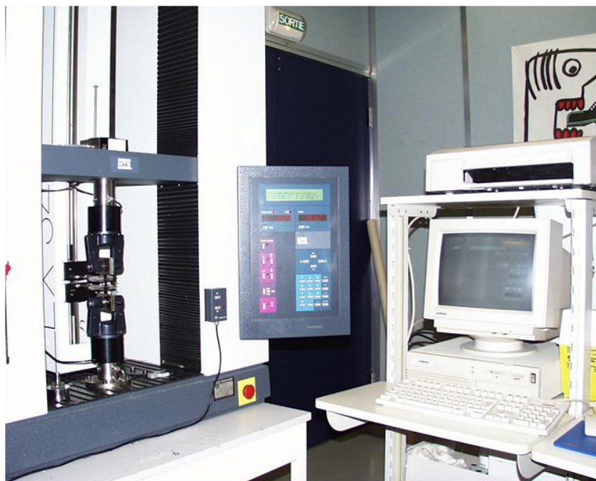
Figure 2.1 – Machine d'essais utilisée pour les essais de traction uniaxiale : dynamomètre + extensomètre + système de pilotage et d'acquisition, située au CTC
