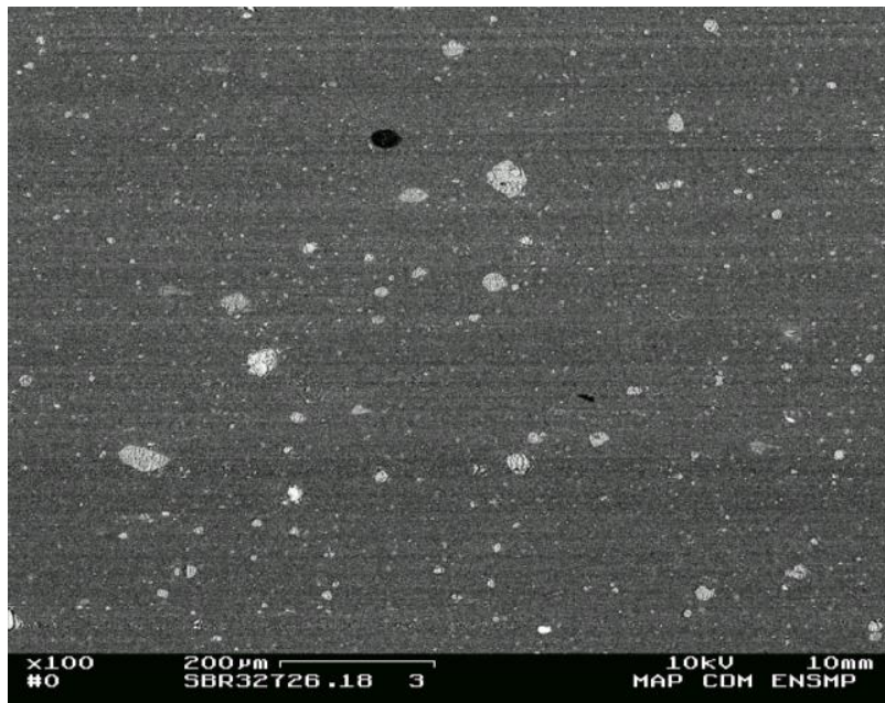
Figure 1A.2 – SBR C – Surface plane observée au MEB : gomme, charges de silice (tâches claires) et de noir de carbone (tâches sombres)
