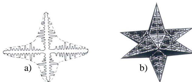
Fig. II.24 [Gro93]: a) Dendrite schématisée et entourée d'une enveloppe idéale passant par l'ensemble des pointes dendritiques. b) Enveloppe simplifiée sous la forme d'un polyèdre.
