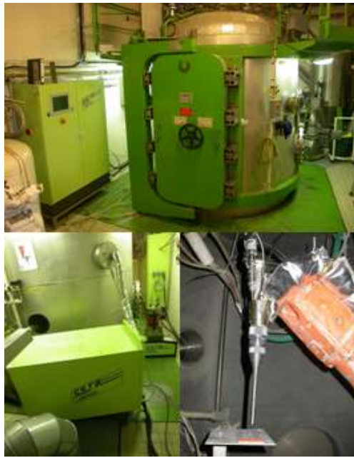
Figure 3 : Dispositif de projection Cold Spray K3000 CGT sur équipement CAPS Sulzer Metco à MINES ParisTech
