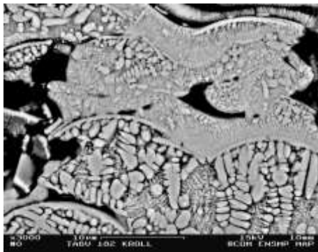
Figure 16 : Vue MEB TA6V HPRPS + attaque chimique Kroll, [TH9]
