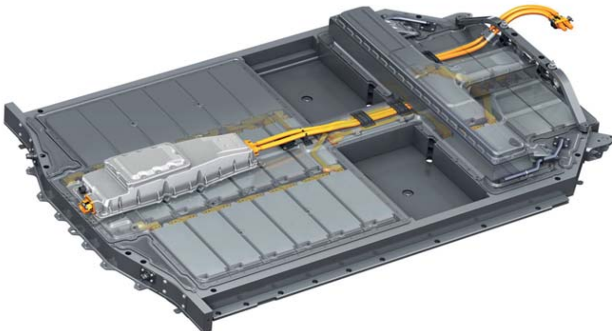
Composition d'une batterie de véhicule électrique - ©Veolia
