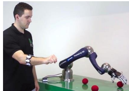
Exemple de commande gestuelle d'un robot (ici avec un capteur musculaire de type EMG). 4
