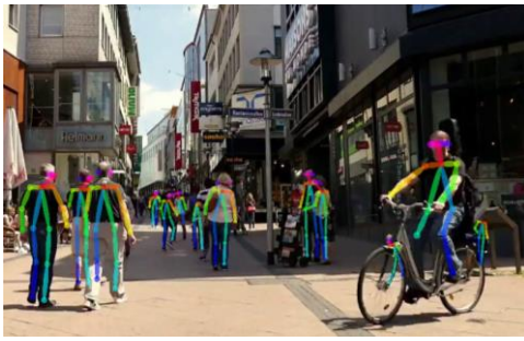
Percées récentes des réseaux convolutifs profonds : à gauche, inférence des postures humaines ; à droite, estimation approchée des distances (image de profondeur en dessous).
