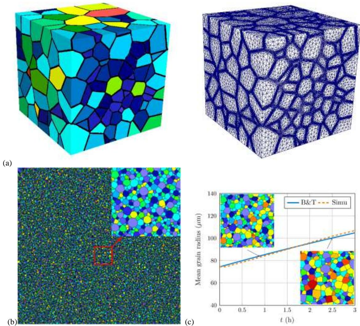
**Figure 1.** (a) Représentation 3D d'un polycristal et maillage éléments finis correspondant (maillage anisotrope aux abords des joints de grains), (b) représentation 2D d'un polycristal d'acier 304L (incluant 50000 grains) et (c) évolution de la microstructure décrite en (b) au cours d'un maintien isotherme à 1050°C calculée par l'approche level-set décrite dans cet article, comparée avec le résultat du modèle classique de Burke et Turnbull [11, 14].
