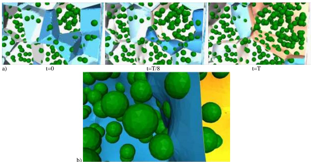
**Figure 3.** (a, de gauche à droite) Simulation en 3D de la croissance de grains dans l'Inconel™ 718, contenant des particules de seconde phase (sphères vertes); (b) zoom en  $t=T$  sur l'interaction entre un joint de grains (surface bleue) et quelques particules de seconde phase.
