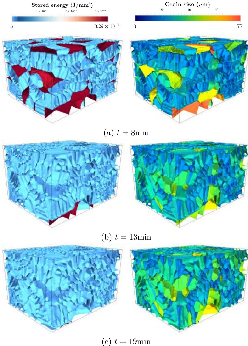
**Figure 2.** Evolution de la microstructure de l'acier 304L par recristallisation statique à 1050°C [12]. Le code de couleur traduit le niveau d'énergie stockée pour la colonne de gauche et la taille de grains pour la colonne de droite.
