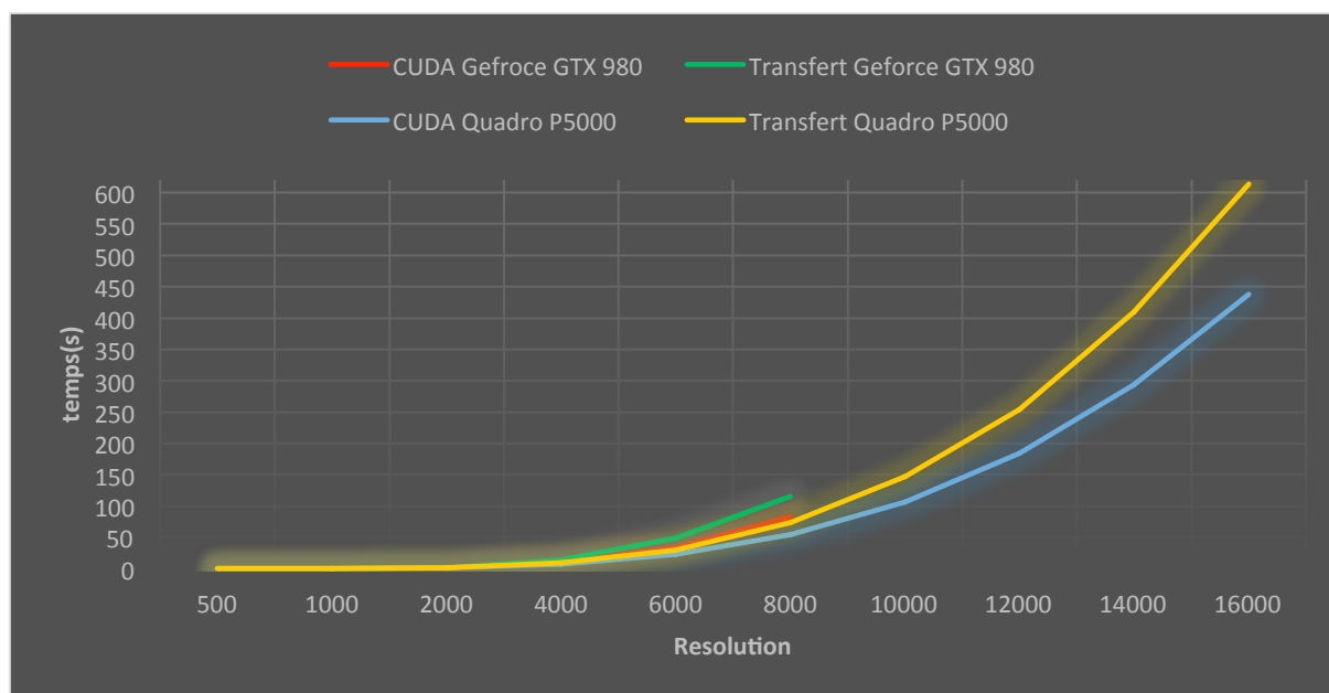
Figure 14 : temps de transfert par rapport le temps de calcul de l’empreinte
