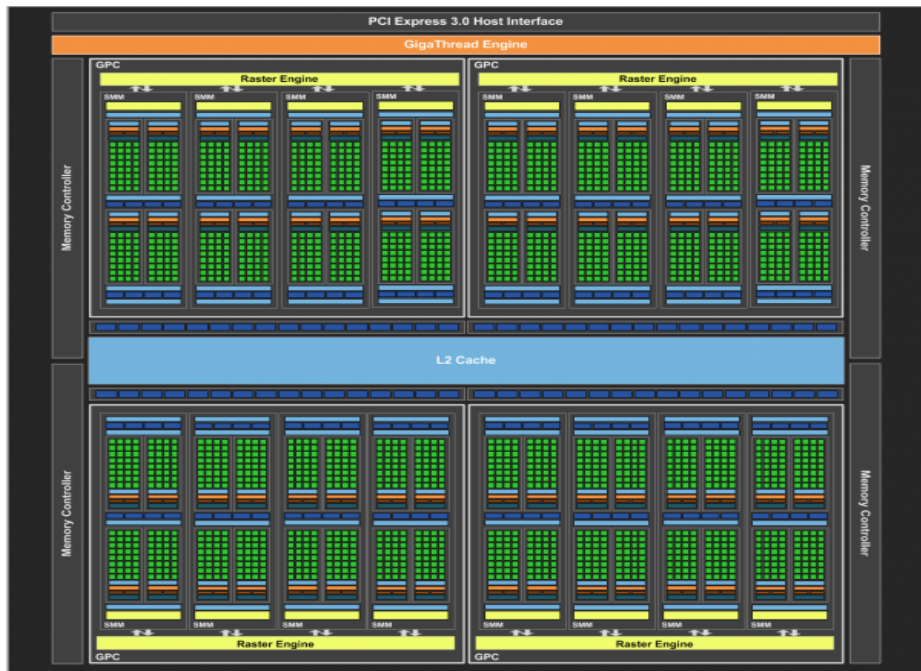
Figure 1: Organisation globale de l'architecture Maxwell (GeForce GTX980)
