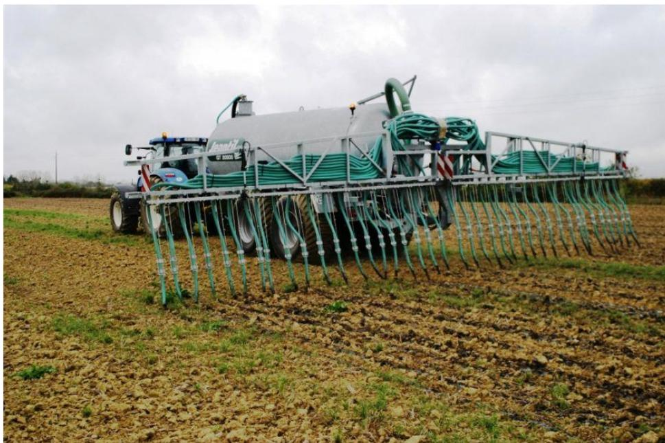
Figure 11 - Epandeur à pendillards
