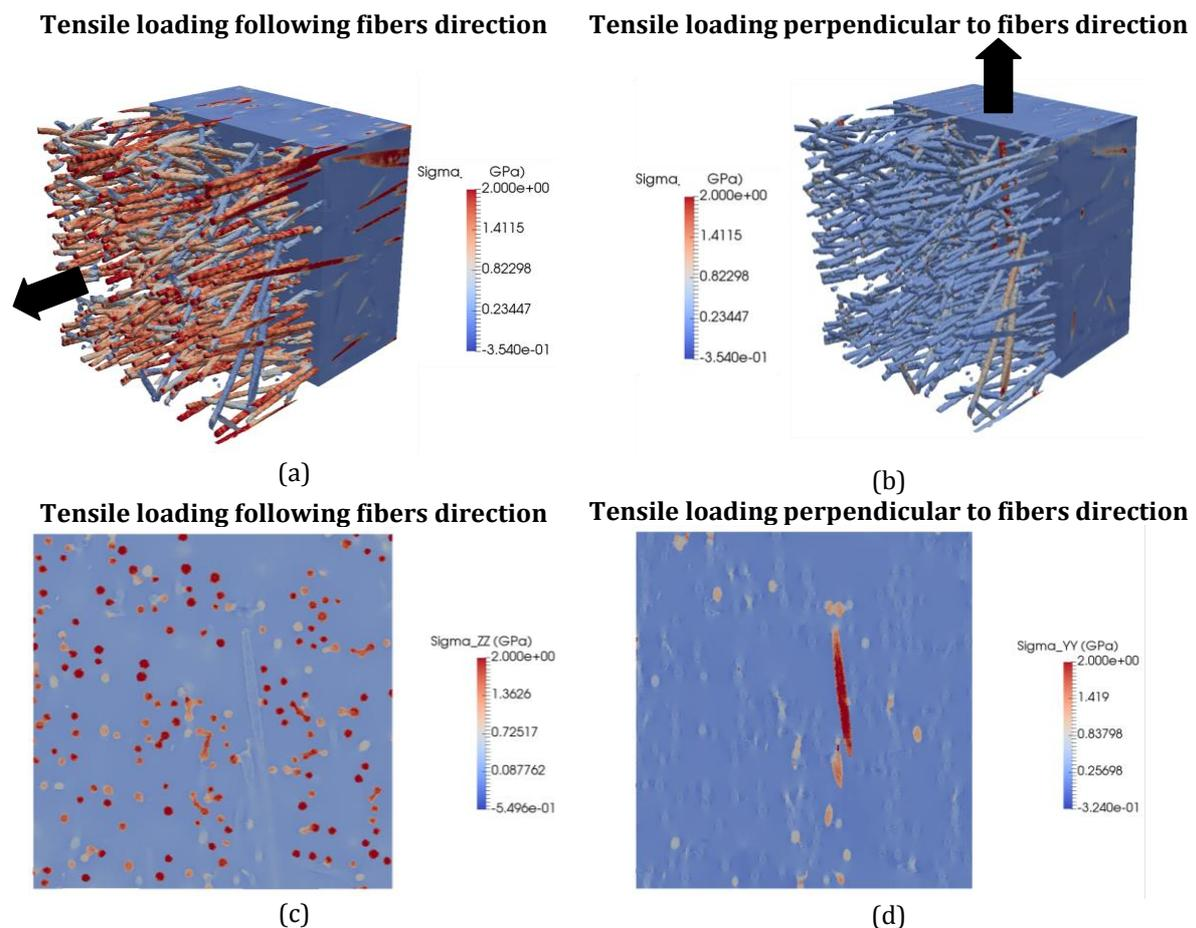
**Fig. 3** Champ de contrainte local dans le VER: (a) pour une simulation réalisée pour un chargement dans la direction des fibres; (b) pour une simulation réalisée pour un chargement dans la direction perpendiculaire à l'orientation des fibres; (c) coupe du VER simulé dans la direction des fibres; (s) coupe du VER simulé dans la direction perpendiculaire à l'orientation des fibres;
