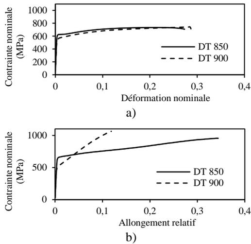
Figure 2. Comportement des deux nuances en traction simple a) à température ambiante, b) à  $-50^{\circ}\text{C}$
