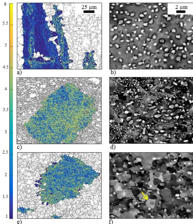
Figure 3. Evolution des grains restaurés à différentes étapes du plan d'expériences. Colonne de gauche : gradient de désorientation calculé selon la méthode décrite par Moussa et al. (en  $^{\circ}/\mu\text{m}$ ). Colonne de droite :
