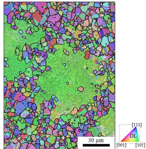
Figure 4. Recrystallisation statique partielle des grains restaurés lors de la mise en solution ( $\epsilon=1,59$ ). Cartographie d'orientation, code couleur identique à fig. 1, et joints de grains (Seuil  $10^{\circ}$ , joints de macles exclus).
