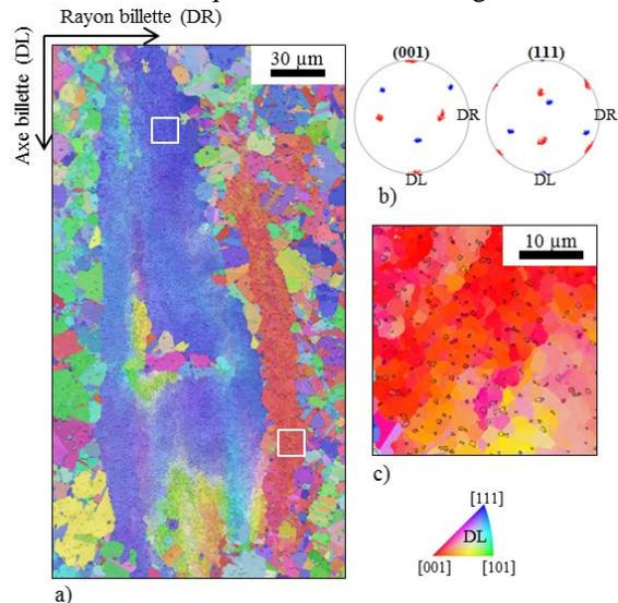
Figure 1. Grains restaurés dans une billette 12'' d'AD730<sup>TM</sup>. (état A de la fig. 2). a) Cartographie d'orientation, le code couleur (triangle standard) indique la direction cristallographique parallèle à DL. b) Figures de pôle des zones rouge et bleue encadrées en blanc sur 1.a). c) Cartographie d'orientation avec gros précipités (contours noirs) identifiés par couplage EDS-EBSD.
