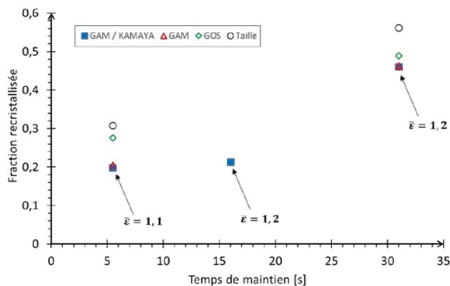
Figure 3. Cinétique de recristallisation en régime post-dynamique pour les conditions de déformation  $T = 980^{\circ}C$ ,  $\dot{\epsilon} = 0,1s^{-1}$  et un niveau de déformation local  $\bar{\epsilon}$  indiqué sur le graphe. Différentes méthodes pour quantifier de la fraction recristallisée à partir de cartographies EBSD sont aussi comparées.
