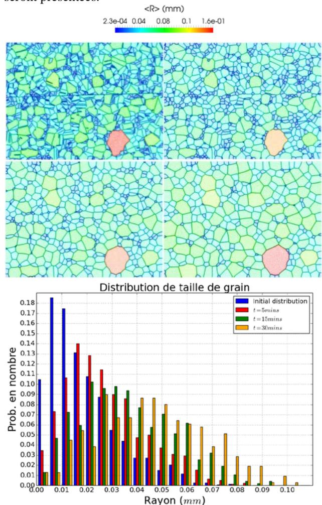
Figure 4. Evolution en temps pour un cas de croissance de grains (30min, 1.4404, 1050°C) sur la microstructure 2D décrite en Figure 2. De haut en bas et de gauche à droite :  $t=0min$ ,  $t=5min$ ,  $t=15min$ ,  $t=30min$  et évolution de la distribution de taille de grains.
