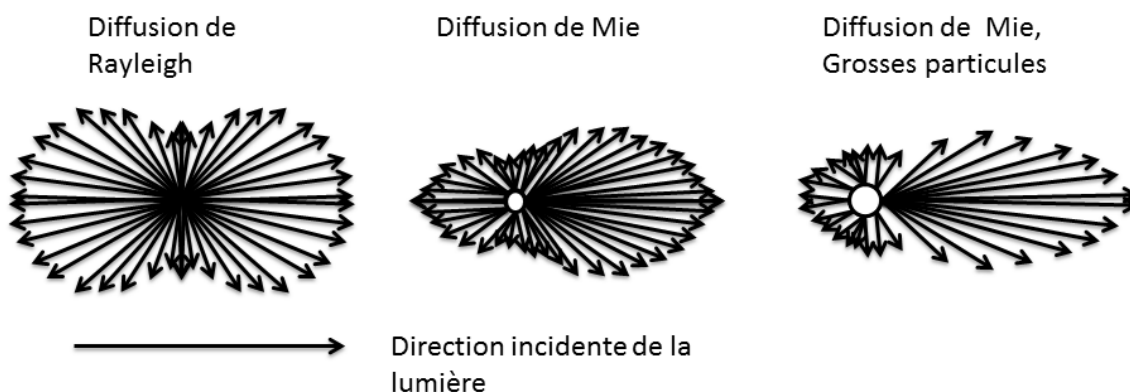
Figure 6 : Diffusion de la lumière dépend de la longueur d'onde du rayonnement et de la taille de la particule diffusante. Plus la particule est grande devant la longueur d'onde plus la diffusion est directionnelle.
