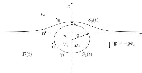
FIGURE 1 – Schéma de l'interface d'une bulle  $S_1(t)$  remontant sous l'effet de la gravité  $\mathbf{g}$  vers une surface libre  $S_0(t)$ . Le liquide occupe le domaine instationnaire  $\mathcal{D}(t)$ .
