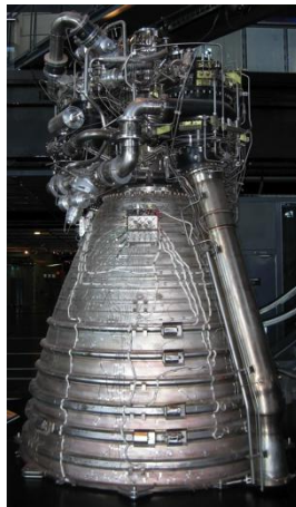
Moteur Vulcain au Musée des Sciences et des Techniques de la Villette à Paris
