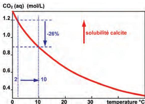
Fig. 30 : Diagramme de solubilité du  $\text{CO}_2$  dans l'eau en fonction de la température. La solubilité du  $\text{CO}_2$  diminue avec l'augmentation de la température, l'échauffement de l'eau conduit à son dégazement.
