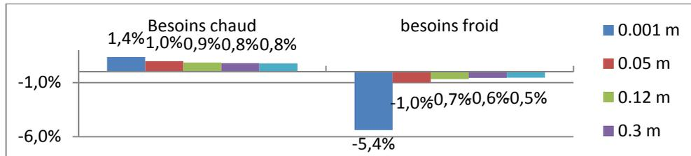
Figure 2: Ecart entre le modèle 26 (référence) et 21 zones selon l'épaisseur d'isolant du plancher
