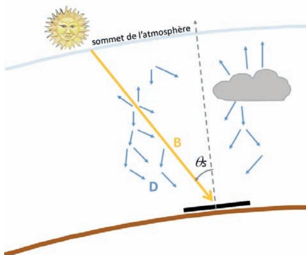
Figure 3. Les composantes directe  $B$  et diffuse  $D$  de l'éclairement global  $G$  reçu au sol sur plan horizontal,  $G = B + D$ .  $\theta_s$  est l'angle solaire zénithal.
