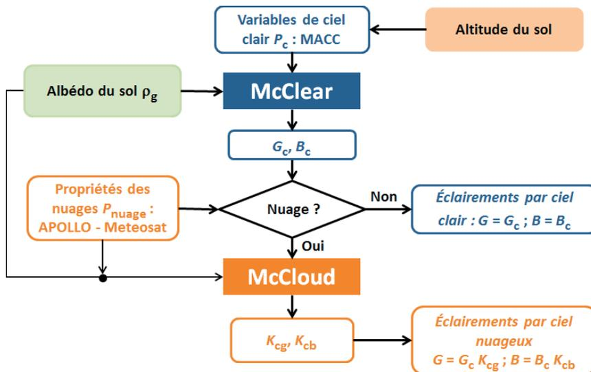
Figure 7. Schéma de la nouvelle méthode Heliosat-4.
