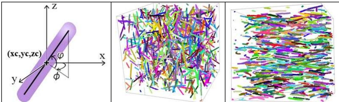
Fig. 10: A gauche, paramètres utilisés pour définir un sphéro-cylindre. Au centre, schéma Booléen de sphères d'orientation uniforme ( $V=300^3$ ,  $l=50$ ,  $r=2$ ,  $Vv=0.02$ ). A droite, schéma Booléen de sphéro-cylindres orientés ( $V=300^3$ ,  $l=50$ ,  $r=2$ ,  $Vv=0.02$ ,  $x=\pm 15^\circ$ ).
