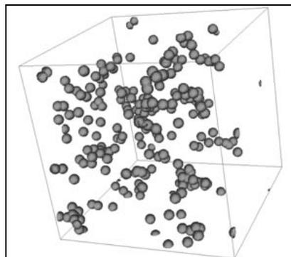
Fig. 9: Simulation du matériau nanocomposite. Nous pouvons observer qu'il n'y pas d'agrégat de sphères noir de carbone percolant en utilisant les fractions volumiques initiales (cf. Tab. 2).
