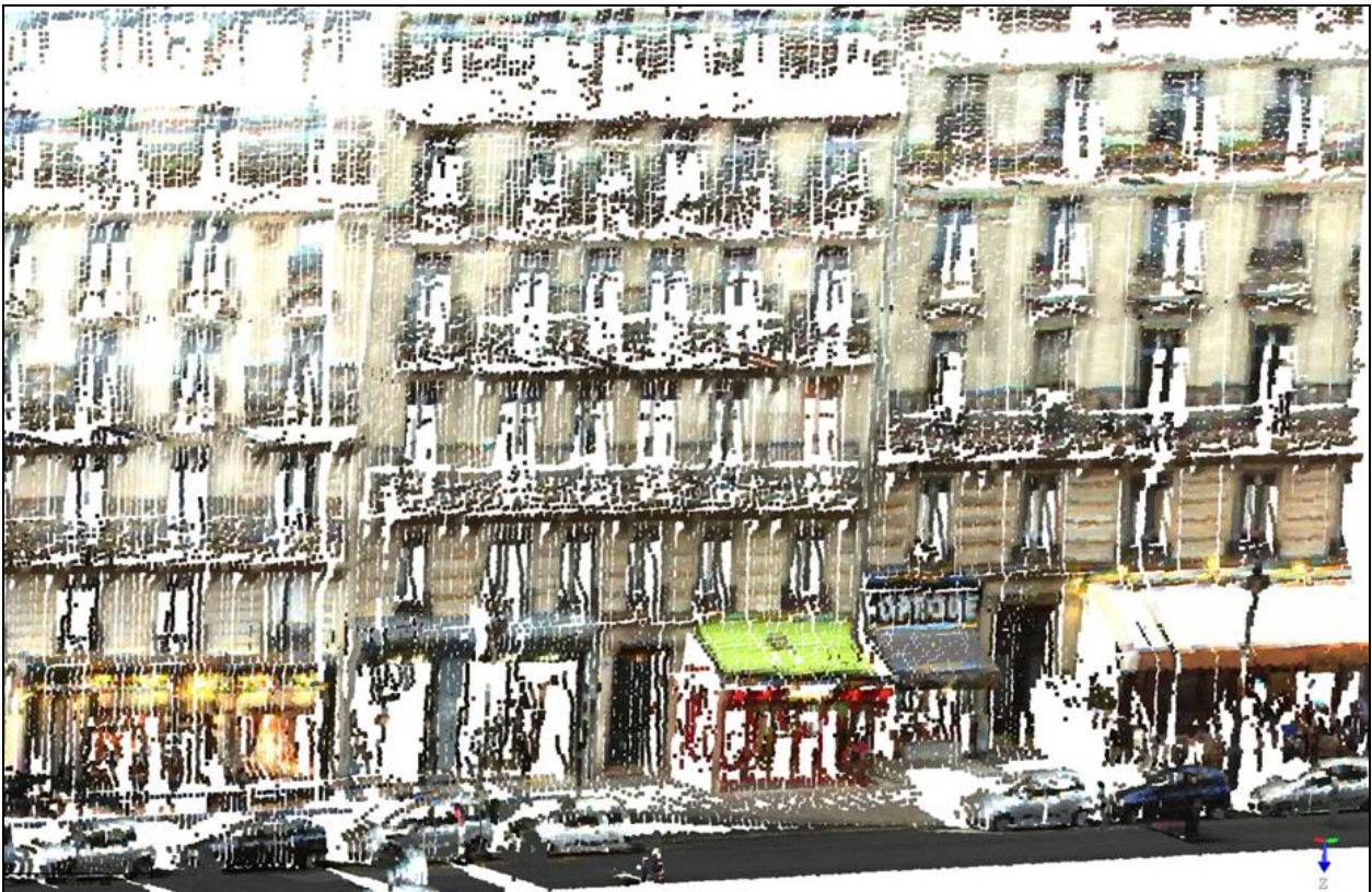
Figure 17 Nuage de points colorés avec caméra haute résolution
