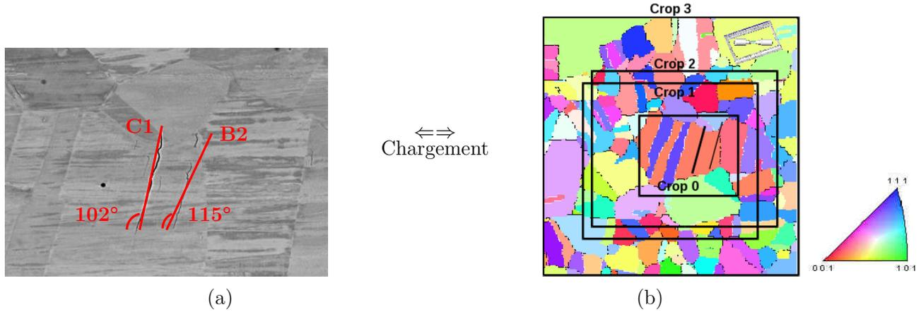
FIGURE 1 – (a) Microfissure transgranulaire dans le grain central, (b) Cartographie EBSD de la région étudiée au voisinage de la fissure. Illustration des tailles de maillage.
