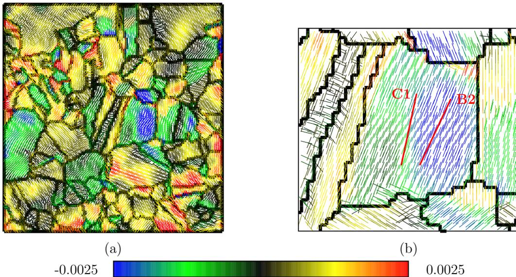
FIGURE 5 – Indicateur d'intensité et d'orientation des PSM de l'agrégat F30 crop3 (a) sur la surface libre  $Z_1$  (b) zoom au niveau du grain central à la fin du second cycle. Les traits rouges indiquent la position des fissures observées expérimentalement.
