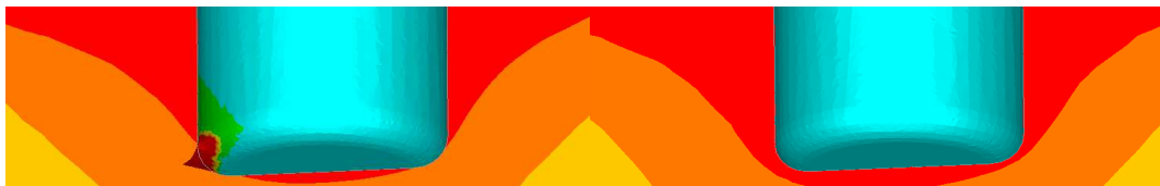
Fig. 8. Etat de contact sur le pion avec un pion non fileté (gauche) ou fileté (droite) (température dans le plan)
