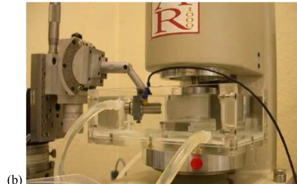
Figure 23. (a) Schéma général et (b) photographie du dispositif de rhéovélocimétrie USV. Extrait de [82]
