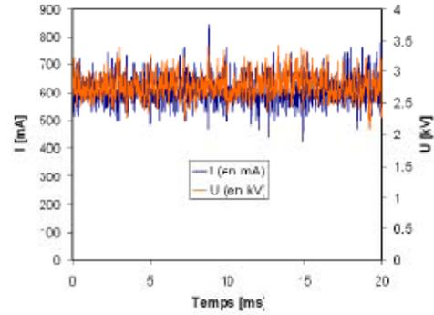
FIG.2. Exemple de post-décharge et son oscillogramme associé.
