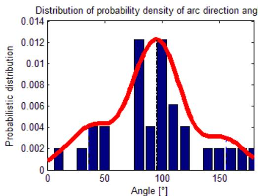
Figure 2. En rouge, courbe de la densité de probabilité de l'angle du vecteur vitesse instantanée du centre de la colonne d'arc. En bleu, histogramme statistique.
