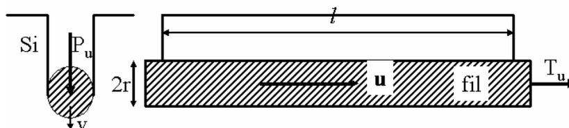
Fig. 2 Contact entre un brin de fil et le bloc de silicium
