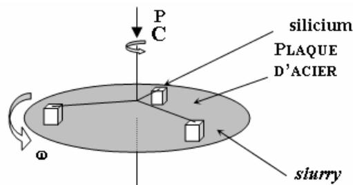
Fig. 3 Dispositif pour la simulation expérimentale du processus d'abrasion du silicium
