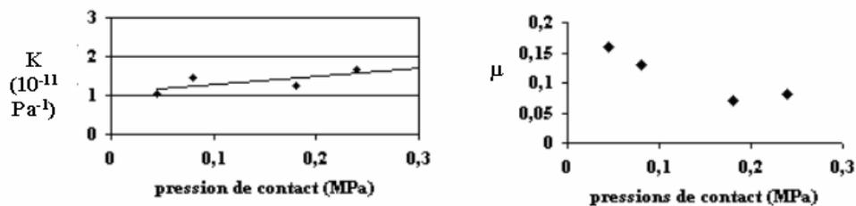
Fig. 4 Influence de la pression de contact p sur la vitesse d'enlèvement de matière K et le coefficient de frottement μ selon la simulation sur tribomètre
