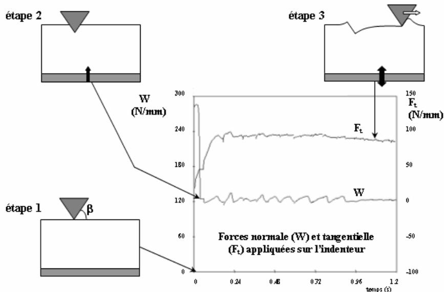
Fig. 6 Conditions de la simulation numérique de l'interaction grain abrasif/silicium
