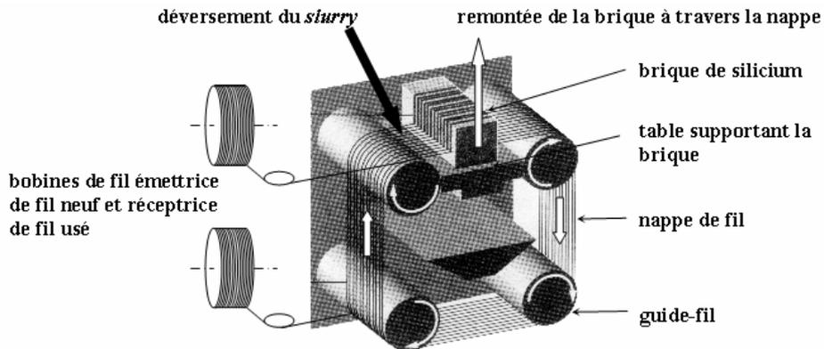
Fig. 1 Le procédé de sciage à fil d'un bloc de silicium
