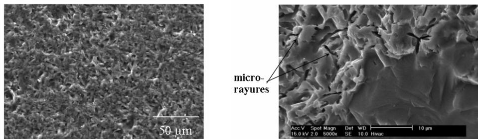
Fig. 5 Observation au microscope électronique à balayage à deux grossissements de la surface des plaques après découpe : le sciage à fil produit des micro-rayures
