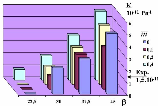
Fig. 9 Influence de l'angle d'attaque  $\beta$  et du coefficient de frottement local  $\bar{m}$  sur la vitesse d'enlèvement de matière  $K$
