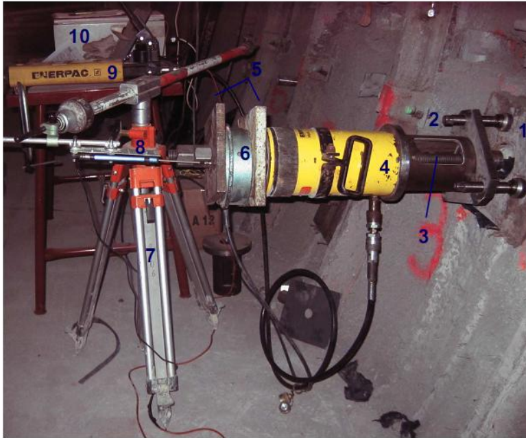
Figure 8 : banc d'arrachement in situ (image adaptée de (Dénécé, Leleu, & Beth, 2009)).
