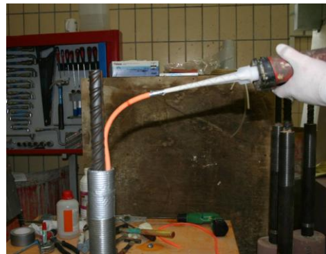
Figure 8 : Outil pour le scellement de la tige dans le tube métallique et vue pendant l'opération
