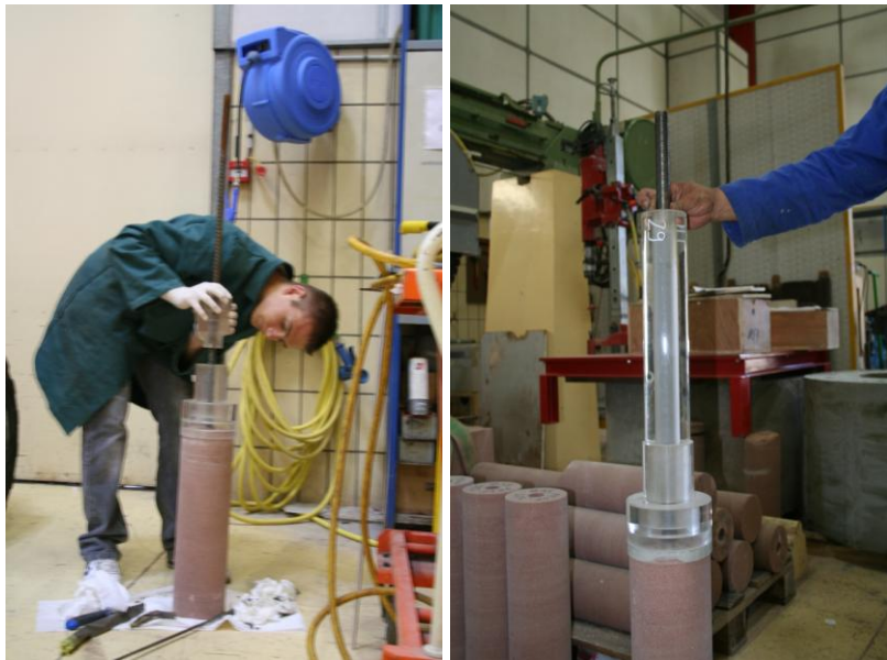
Figure 7 : Pièces en plexiglas conçues pour le centrage du boulon et du tube métallique et vue de deux étapes du processus de mise en place
