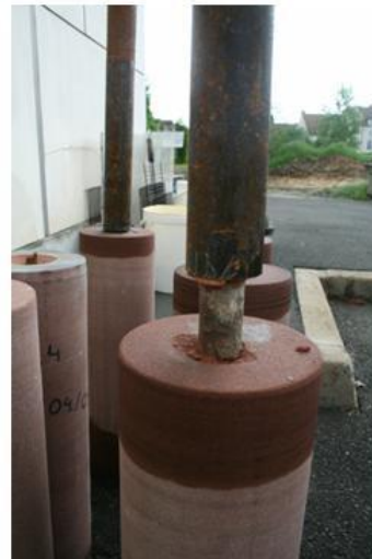
Figure 10 : Résultat de l'essai d'arrachement pour L=150mm, P=5MPa, scellement à la résine
