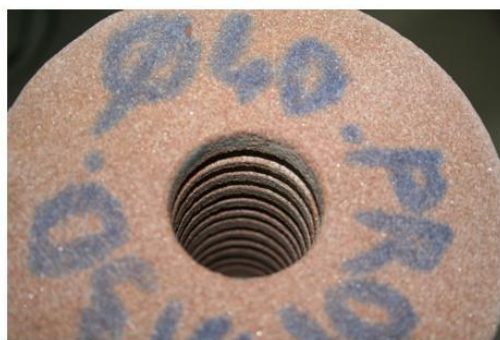
Figure 5 : Vue du tour pendant le rainurage d'un échantillon de grès. Vue des rainures créées
