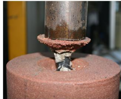
Figure 11 : Résultat de l'essai d'arrachement pour L=100\text{mm} , P=5,1\text{MPa} , scellement à la résine
