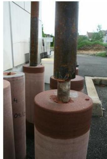
Figure 10 : Résultat de l'essai d'arrachement pour  $L=150\text{mm}$ ,  $P=5\text{MPa}$ , scellement à la résine
