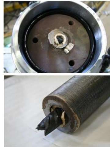
Figure 9 : Résultat de l'essai d'arrachement pour L=300mm, P=15MPa, w:c=0,4
