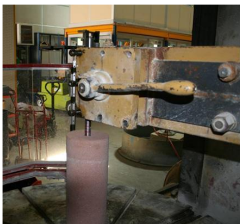
Figure 5 : Vue du tour pendant le rainurage d'un échantillon de grès. Vue des rainures créées
