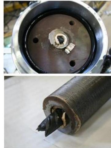
Figure 9 : Résultat de l'essai d'arrachement pour  $L=300\text{mm}$ ,  $P=15\text{MPa}$ ,  $w:c=0,4$
