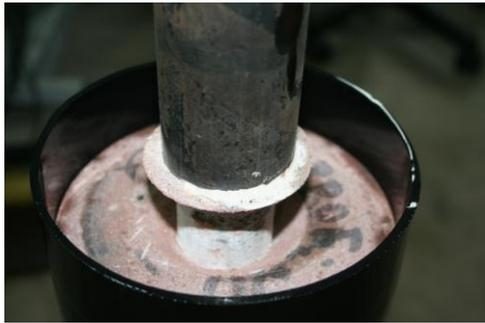
Essai 12 (L=90mm, P=9,81MPa)
