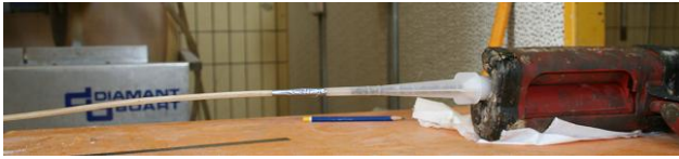
Figure 8 : Outil pour le scellement de la tige dans le tube métallique et vue pendant l'opération
