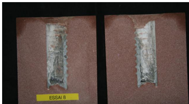
Figure 20 : Vue du trou borgne après essai. Influence du rainurage sur le type de rupture obtenu
