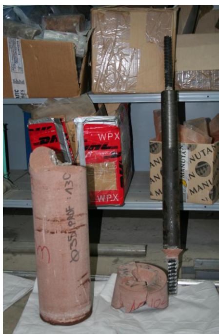
Figure 21 : Vue de l'échantillon 11 après essai. Rupture de la carotte de grès (essai effectué à P_{\text{atm}} )
