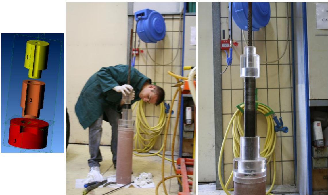
Figure 11: pièces en plexiglas pour le centrage du boulon et du tube métallique et vue de deux étapes du processus de mise en place
