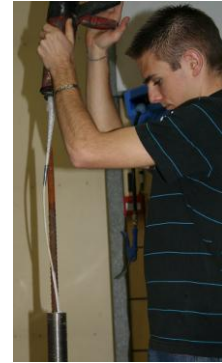
Figure 12: outil pour le scellement de la tige dans le tube métallique et vue pendant l'opération
