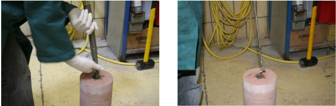
Figure 10: insertion et mélange de la résine dans l'échantillon de grès
