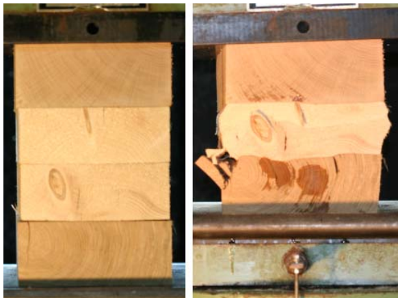
Fig. 41 : Essai sandwich en compression simple
