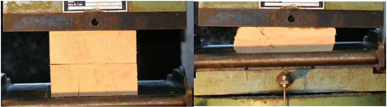
Fig. 37 : Photos de l'essai en compression simple du sapin
