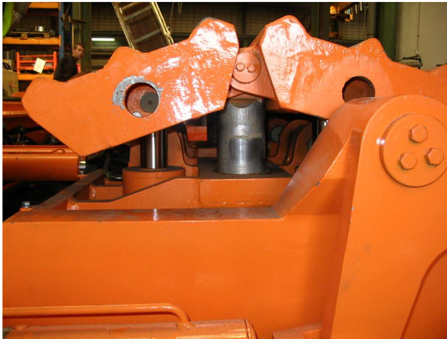
Figure 3-9 : Articulation des grappeurs sur le prototype du projet SCOUT
