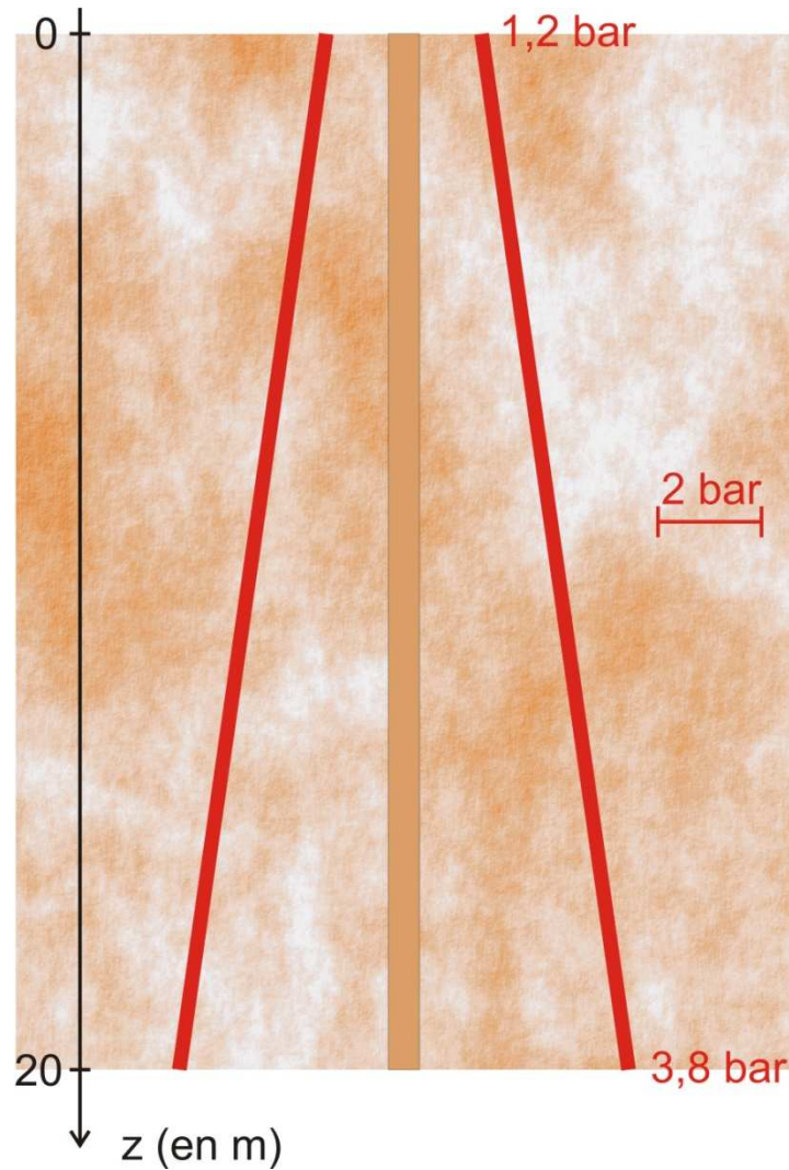
Figure 3-7 : Contrainte maximale à appliquer pour éviter la rupture des parois de la tranchée
