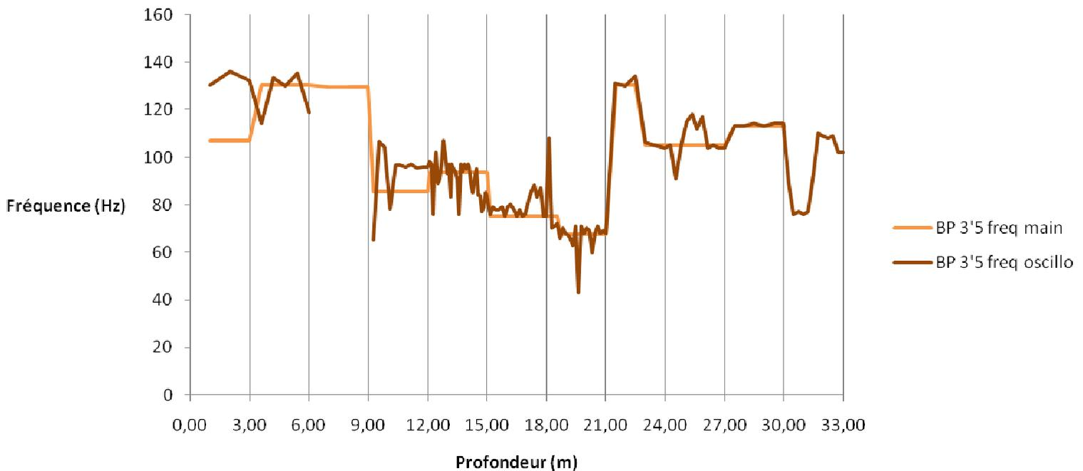
Figure 13 : Courbes fréquence=f(profondeur) pour le forage incliné à 35°
