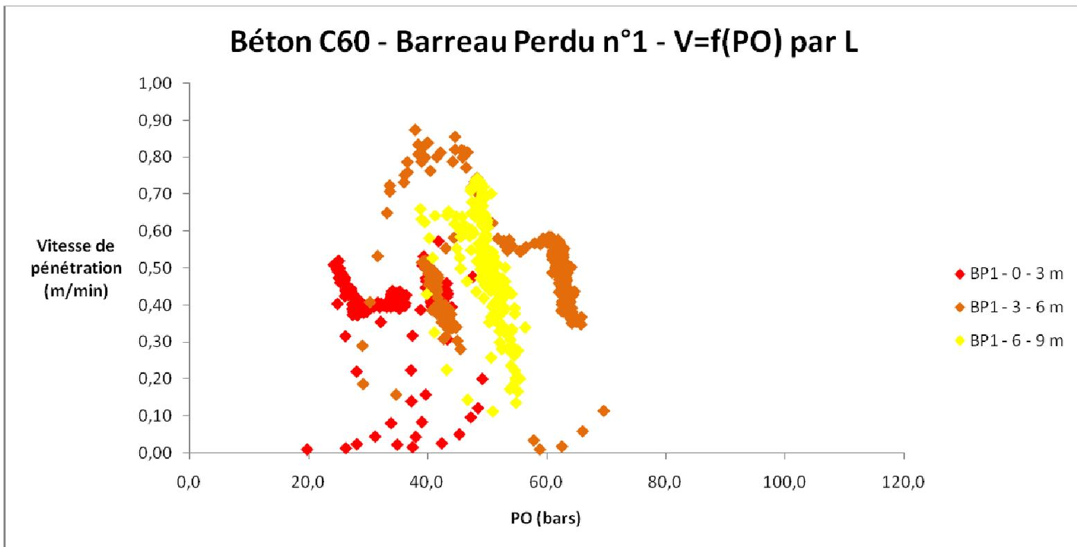
Figure 22 : Nuage des points (PO, vitesse) triés par longueur de train de tige du premier essai dans le béton avec outil à barreau perdu
