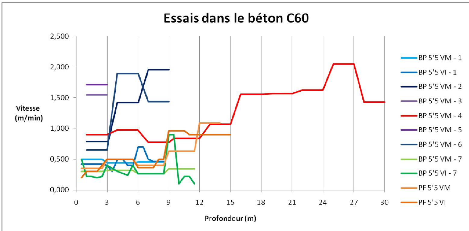
Figure 2 : Représentation des points (profondeur, vitesse de pénétration) non triés pour les essais dans le béton C60
