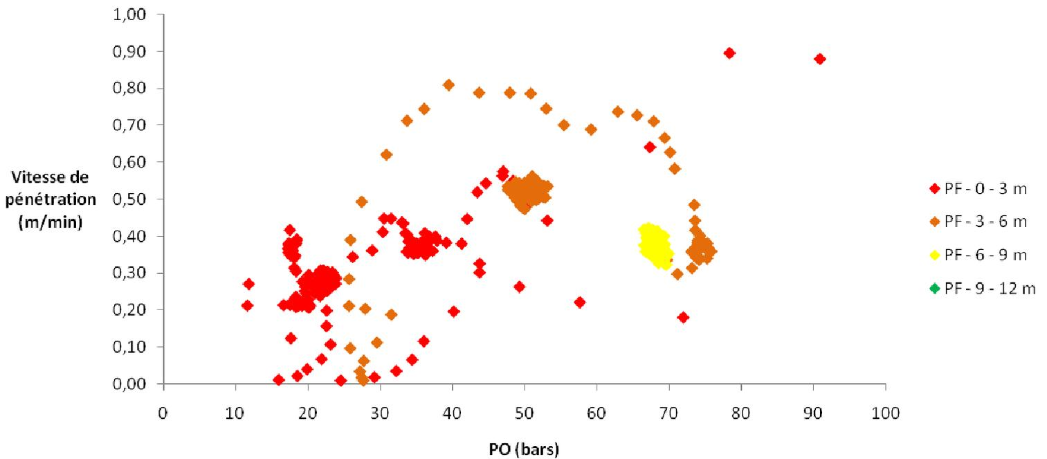
Figure 24 : Nuage des points (PO, vitesse) triés par longueur de train de tige de l'essai dans le béton avec outil pleine face
