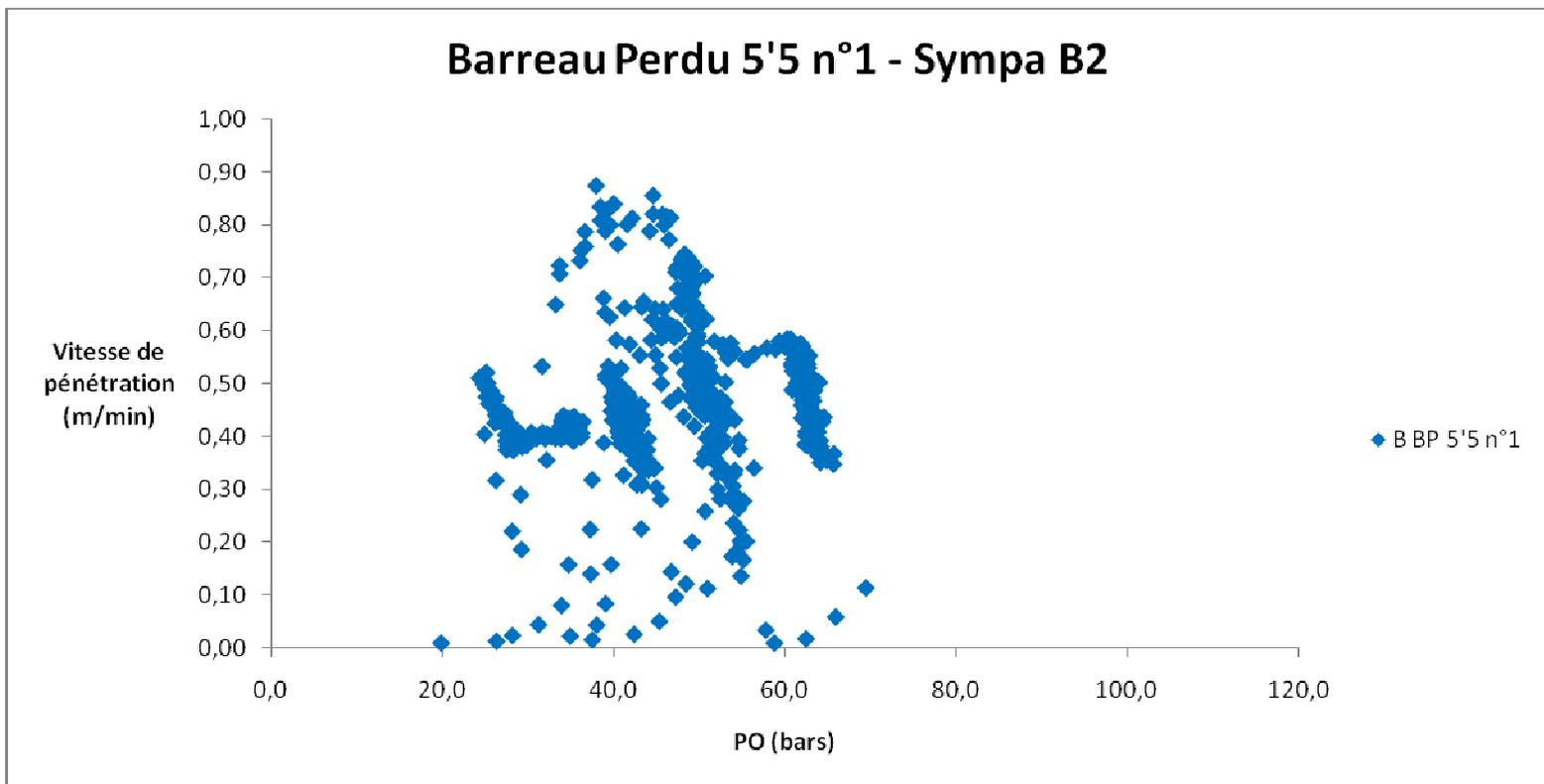
Figure 19 : Nuage des points (PO, vitesse) du premier essai dans le béton avec barreau perdu
