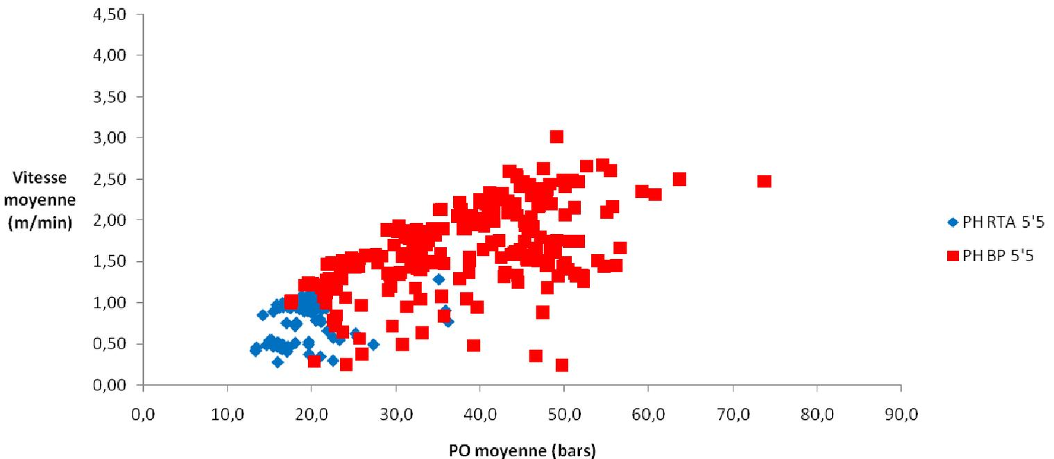
Figure 18 : Nuages de points (PO moyenne, vitesse moyenne) des 2 essais caractérisant les pieux hétérogènes
