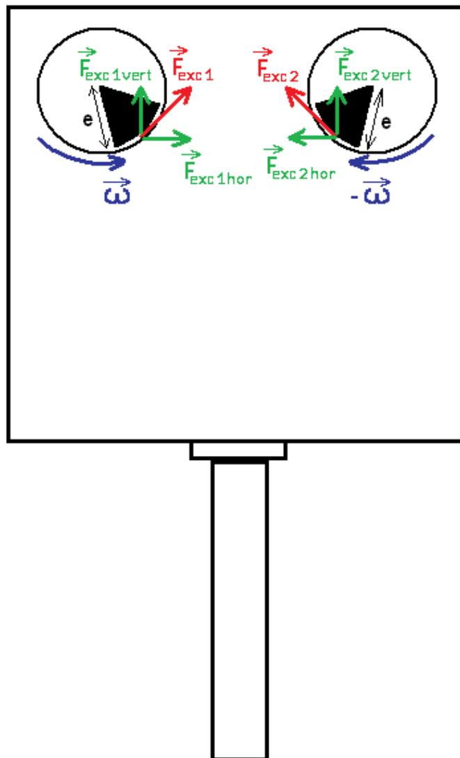
Figure 1 : Schéma de principe de la tête sonique
