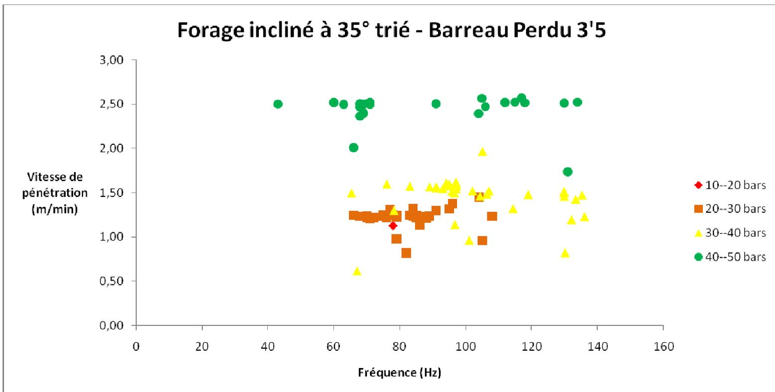
Figure 25 : Nuage des points (fréquence, vitesse) triés par gamme de PO du forage incliné à 35°
