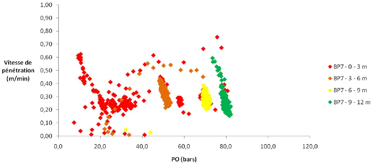
Figure 23 : Nuage des points (PO, vitesse) triés par longueur de train de tige du septième essai dans le béton avec outil à barreau perdu
