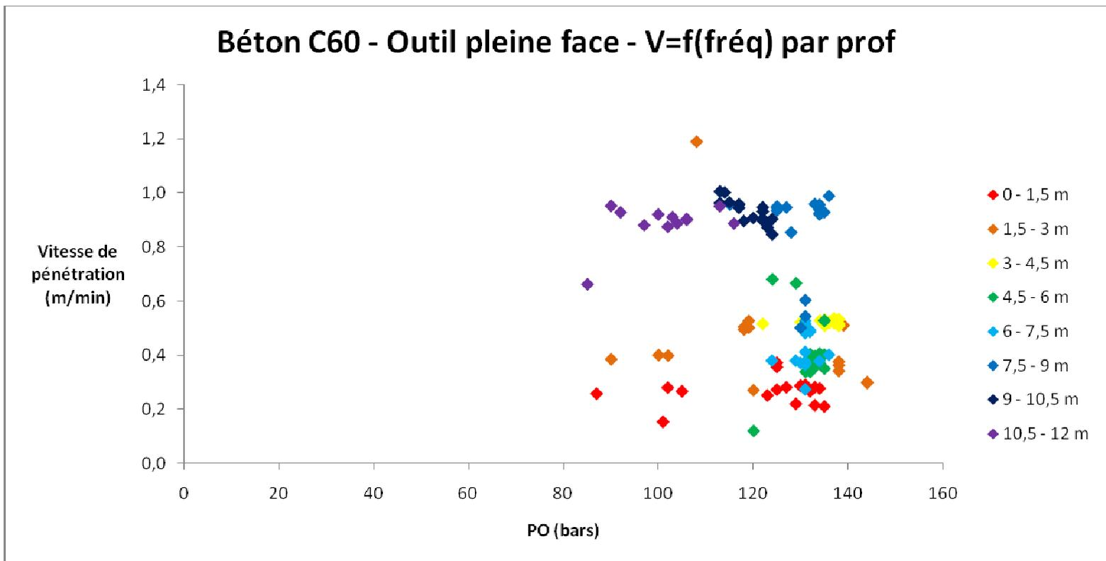
Figure 9 : Représentation des points (fréquence, vitesse moyenne de pénétration) triés par niveau de profondeur pour l'essai dans le béton C60 avec outil pleine face
