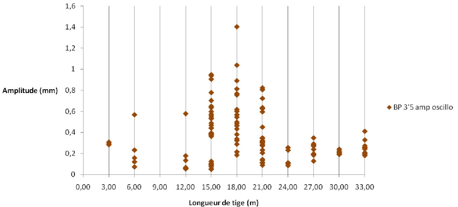
Figure 16 : Nuage de points (longueur de tige, amplitude) pour le forage incliné
