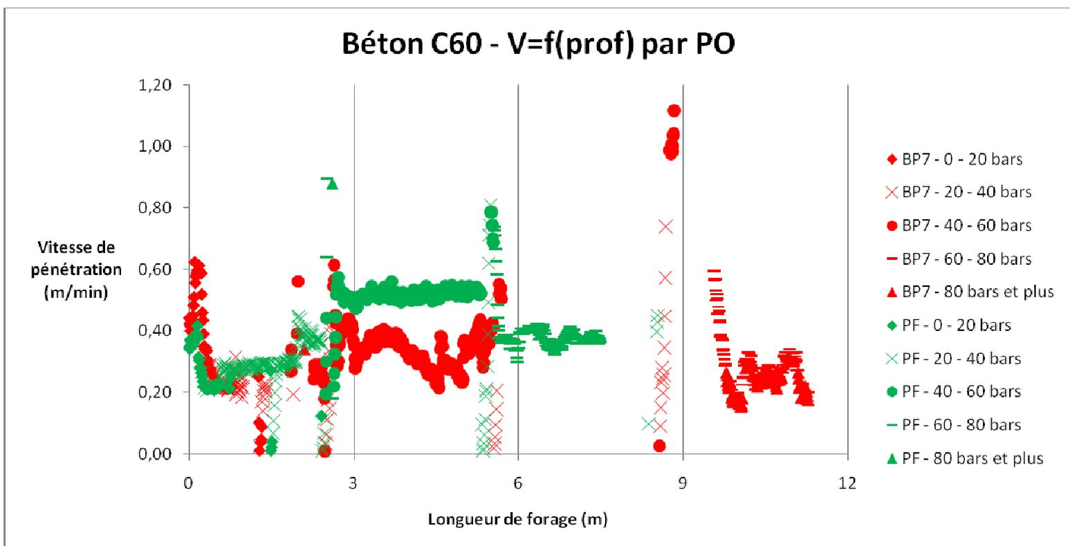
Figure 29 : Evolution de la vitesse de pénétration et de la PO en fonction de la profondeur dans le béton pour plusieurs outils
