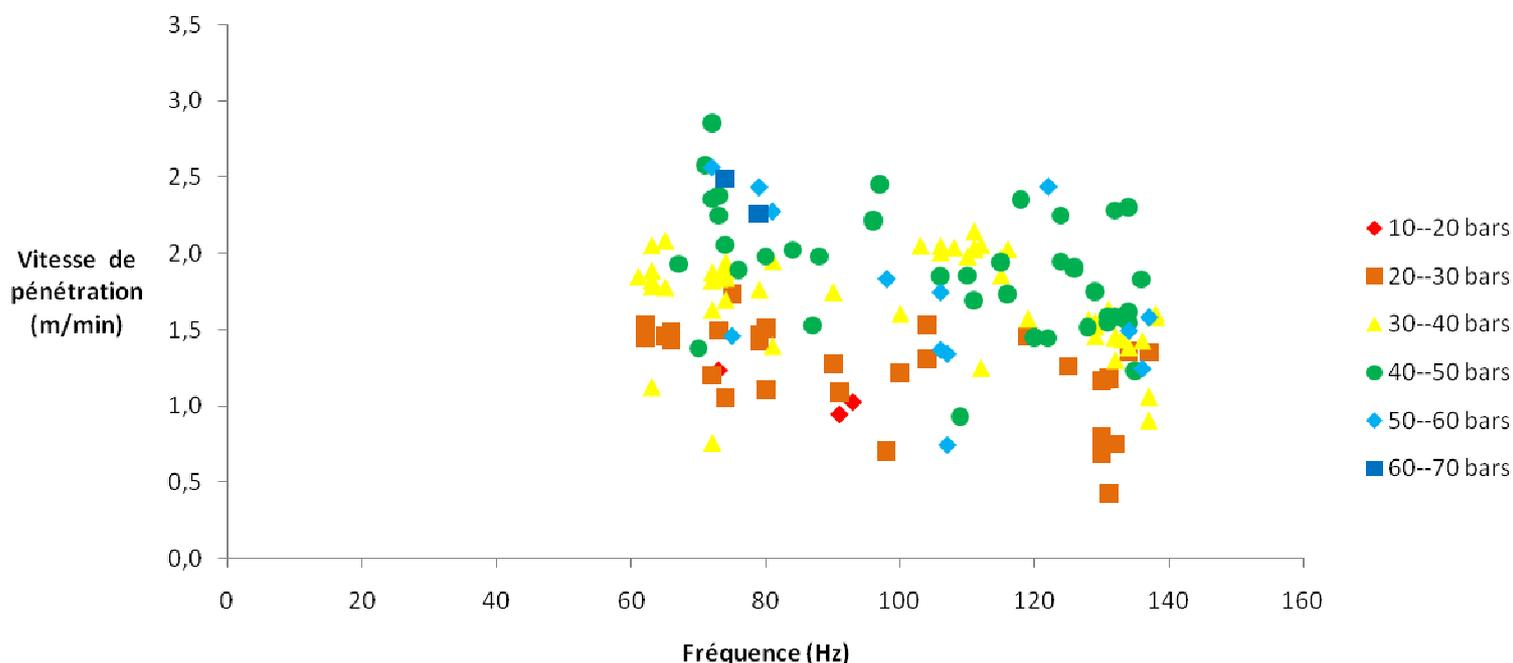
Figure 26 : Nuage des points (fréquence, vitesse) triés par gamme de PO de l'essai en terrain hétérogène avec outil à barreau perdu
