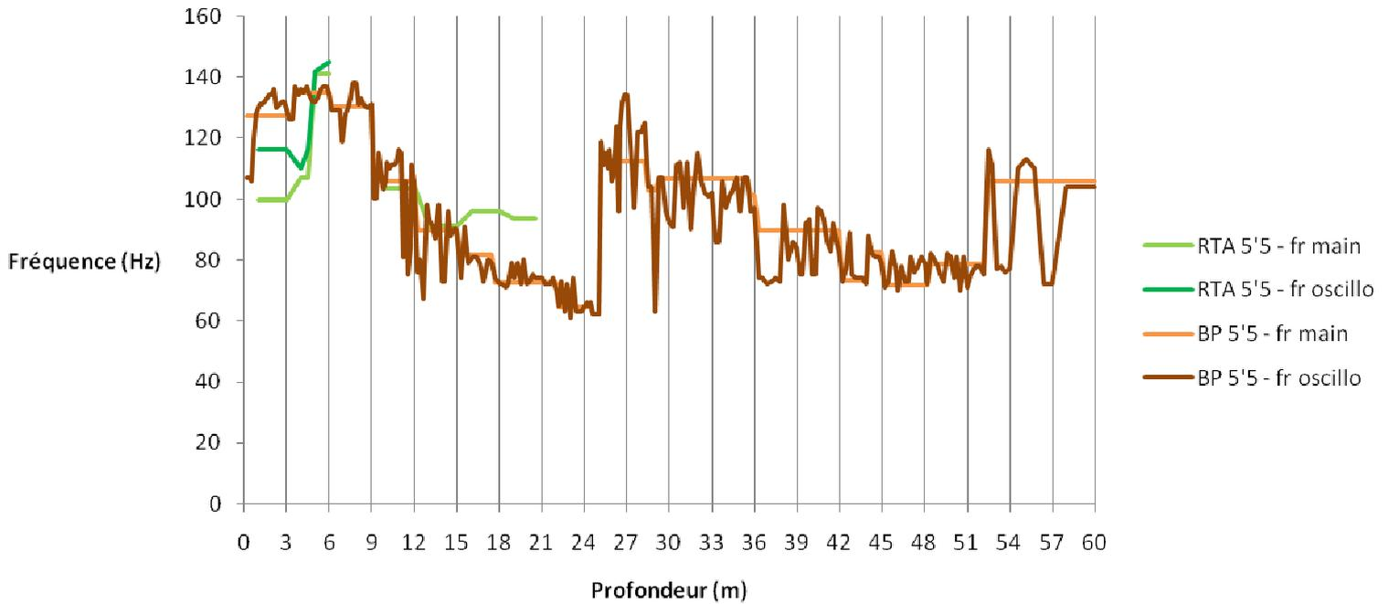
Figure 12 : Courbes fréquence =f(profondeur) pour les essais dans les milieux hétérogènes
