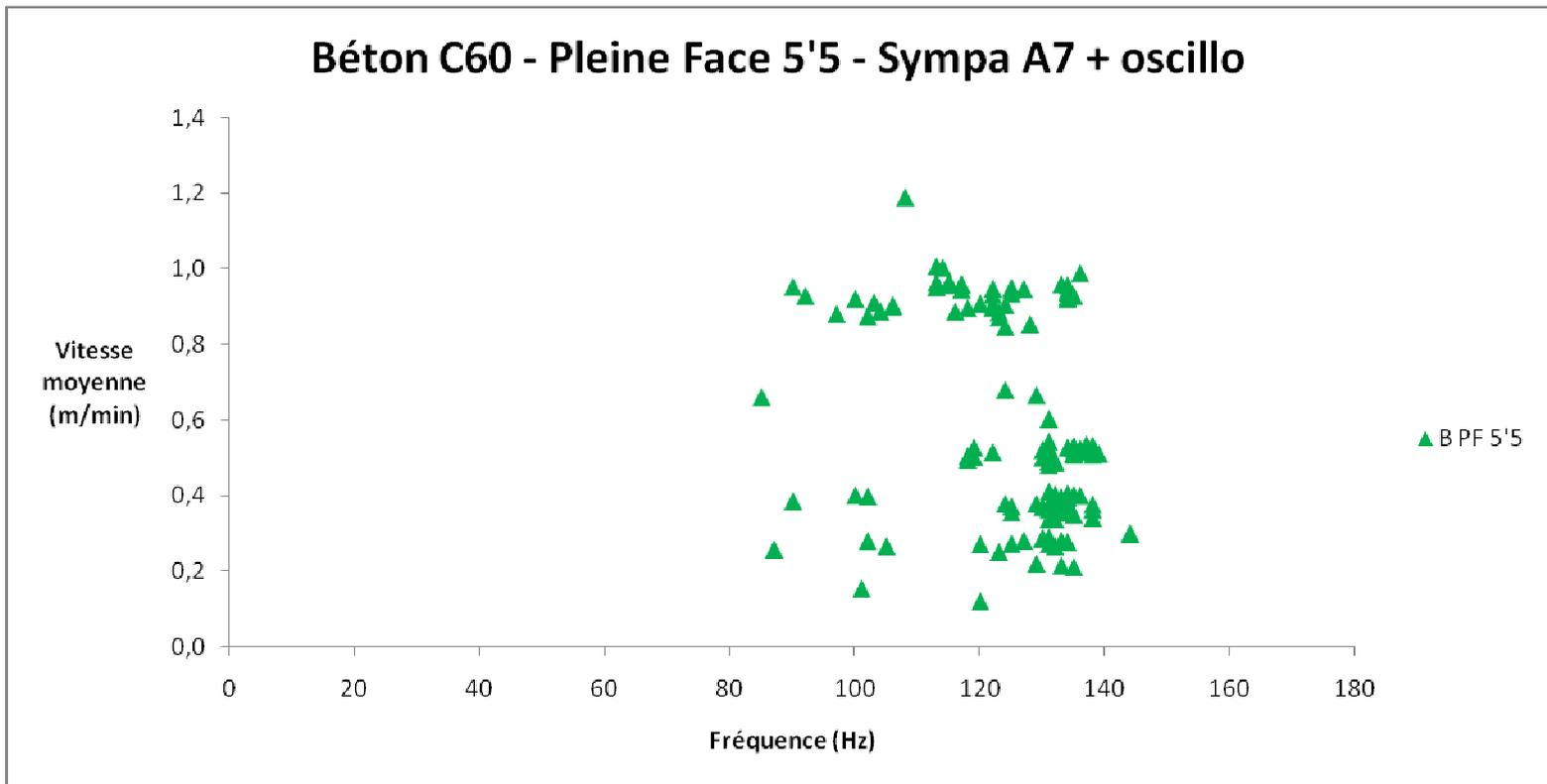
Figure 8 : Représentation des points (fréquence, vitesse de moyenne de pénétration) non triés pour l'essai dans le béton C60 avec outil pleine face
