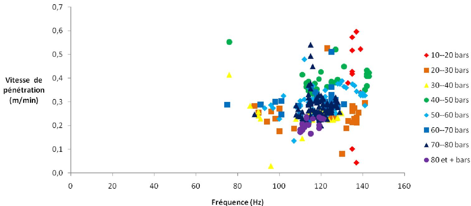
Figure 28 : Nuage des points (fréquence, vitesse) triés par gamme de PO de l'essai dans le béton C60 avec outil à barreau perdu
