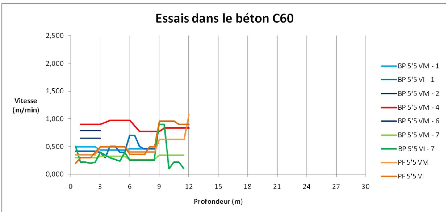
Figure 3 : Représentation des points (profondeur, vitesse de pénétration) triés en fonction de leur niveau de vitesse pour les essais dans le béton C60. Les vitesses trop élevées ont été éliminées
