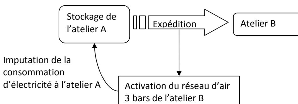
Figure 15 : mise en évidence du lien entre les expéditions et le réseau d'air 3 bars
