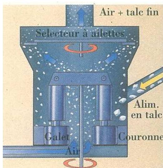
Figure 4 : Principe général de fonctionnement d'un broyeur
