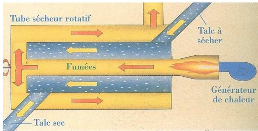
Figure 3: Principe de fonctionnement d'un four rotatif
