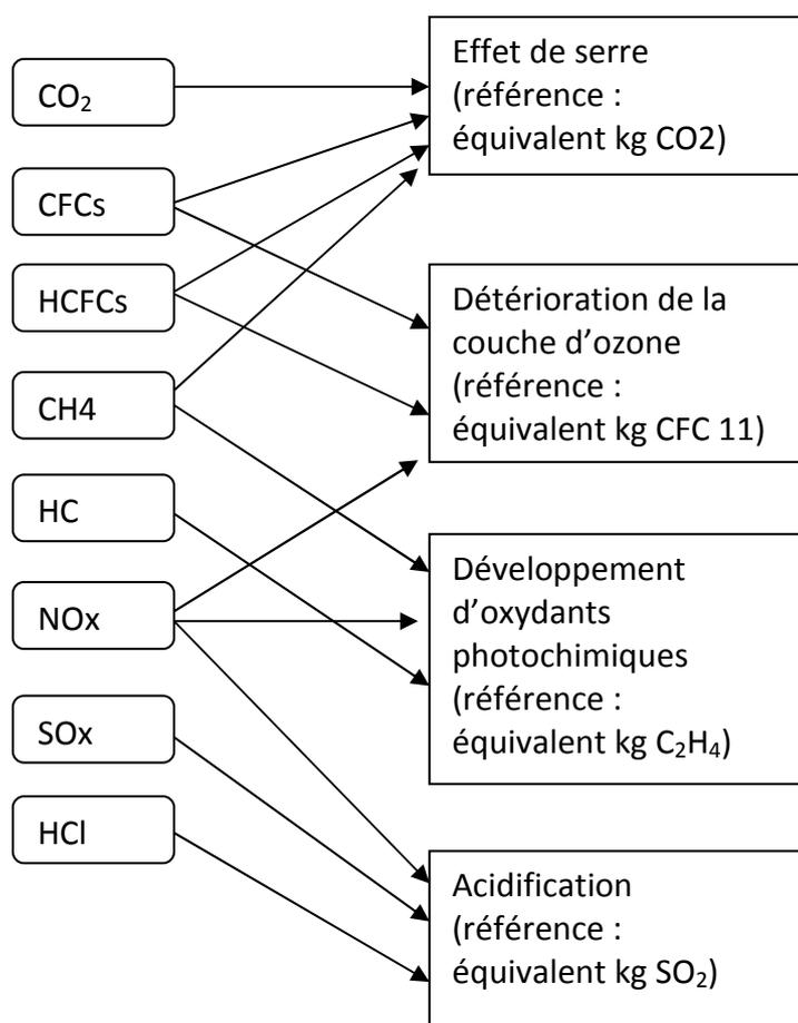
Figure 17 : modélisation du principe de calcul d'impact
