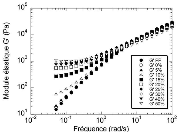
Figure 2: Comparaison des modules élastiques  $G'$  des mélanges PP/PP-g-MA/Cloisite<sup>®</sup>20A en fonction de la concentration en PP-g-MA ( $T_r = 180^\circ\text{C}$ ,  $N = 100 \text{ tr/min}$ ,  $t_m = 10 \text{ min}$ )
