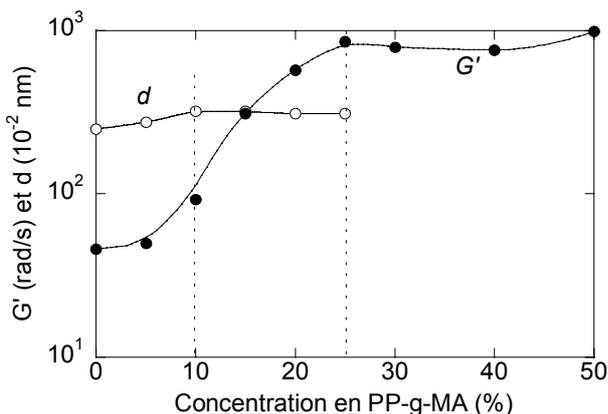
Figure 3: Comparaison entre le module  $G'$  à 0,1 rad/s et la distance interlamellaire  $d$  en fonction de la concentration en PP-g-MA ( $T_r = 180^\circ\text{C}$ ,  $N = 100 \text{ tr/min}$ ,  $t_m = 10 \text{ min}$ )
