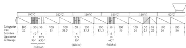
Fig. 1 : Profil de vis utilisé
