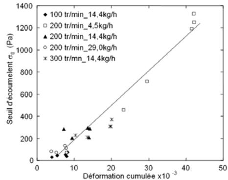
Fig. 9 : Evolution du seuil d'écoulement pour différentes positions et conditions d'extrusion en fonction de la déformation cumulée calculée à l'aide de Ludovic<sup>®</sup>
