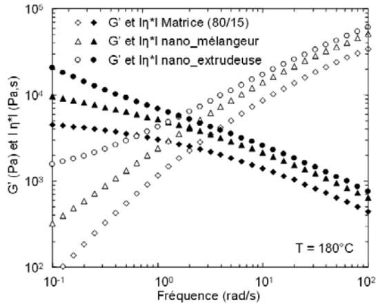
Fig. 1 : Comportement viscoélastique linéaire des nanocomposites
