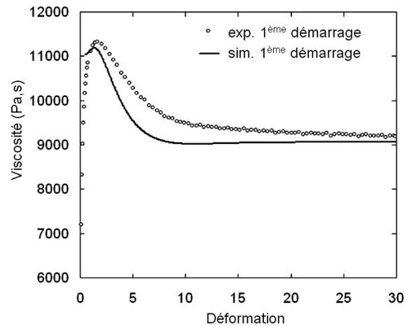
Fig. 7 : Comparaison de la prédiction du modèle et de l'expérience pour le premier démarrage ( $\dot{\gamma} = 0,1 \text{ s}^{-1}$ )
