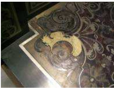
Figure 2 : exemples d'altérations de marqueterie .a) décollement d'élément en laiton ; b) fissuration d'élément en étain
