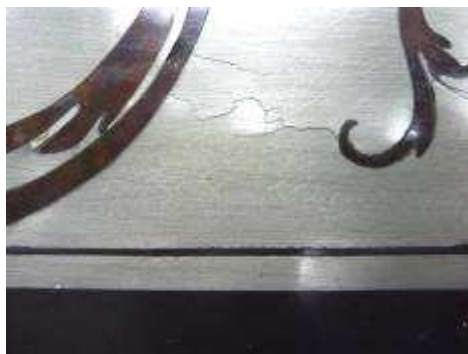
Figure 13 : détail d'un élément en étain fissuré ; noter le réseau plus clair, prémisses de fissuration
