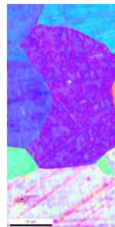
Figure 14. Microstructure après recuit sur la zone fluotournée
