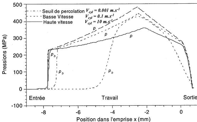
Figure 3 – Effet de la vitesse sur la répartition de pression globale (p = colline de frottement) et de pression fluide p<sub>b</sub>. Conditions de laminage : voir dans le texte.
