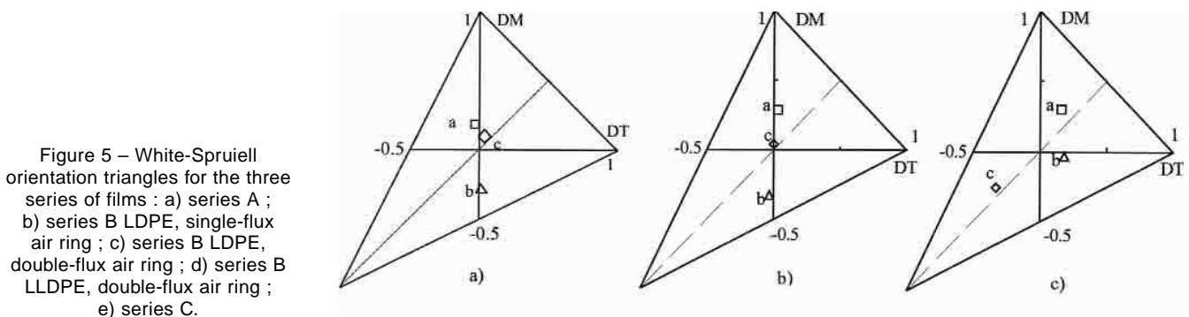
*Figure 5 – Triangles d'orientation de White-Spruiell des trois séries de films :*
