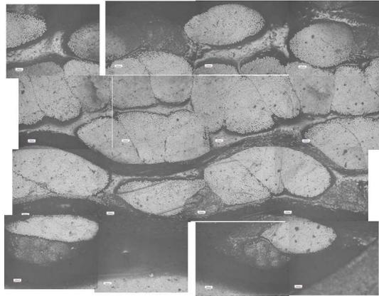
FIG. 1 – Coupe transversale du composite textile.
