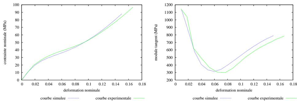
FIG. 2 – Comportement macroscopique du matériau hétérogène (à gauche) dans la direction chaîne et évolution du module tangent (à droite) en fonction de la déformation moyenne  $E_{11}$  imposée.
