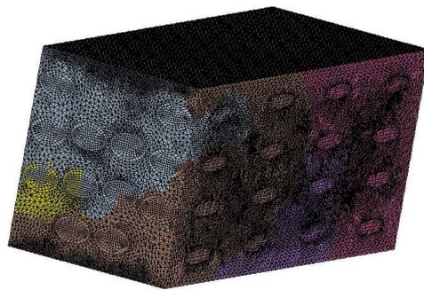
FIG. 4 – Décomposition en 10 sous-domaines du maillage de la cellule périodique.
